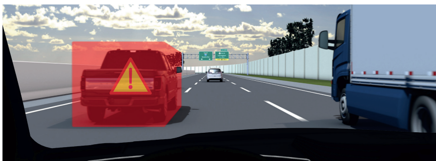
Bild 2: Das System wertet die Aufmerksamkeit des Fahrers aus. Während es die Übergabe der Kontrolle an den Fahrer vorbereitet, stellt es fest, dass er die höhere Gefahr auf der linken Seite nicht wahrnimmt und hebt sie in einem Head-up-Display hervor. © Aptiv
