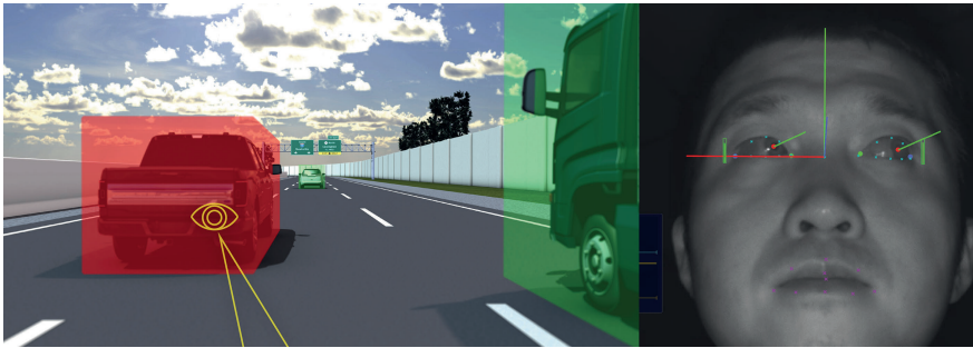
Bild 3: Durch die Hervorhebung des Fahrzeugs, das in die Fahrspur einfährt, wird die Aufmerksamkeit des Fahrers auf das Element in der Umgebung gelenkt, das zum Zeitpunkt der Kontrollübergabe am wichtigsten ist. © Aptiv
